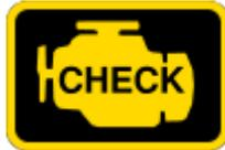
Aufgrund gesetzlicher Vorgaben erfolgt eine Ansteuerung dieser Fehlerlampe bei Fehlfunktionen. Liegt nur eine temporäre Fehlfunktion vor, erlischt die Lampe wieder automatisch nach 3 fehlerfreien Fahrzyklen (Anlassen, Fahren, Abstellen). Der Fehlerspeicher im Steuergerät wird hingegen erst nach 40 fehlerfreien Warmlaufzyklen selbsttätig wieder gelöscht.
